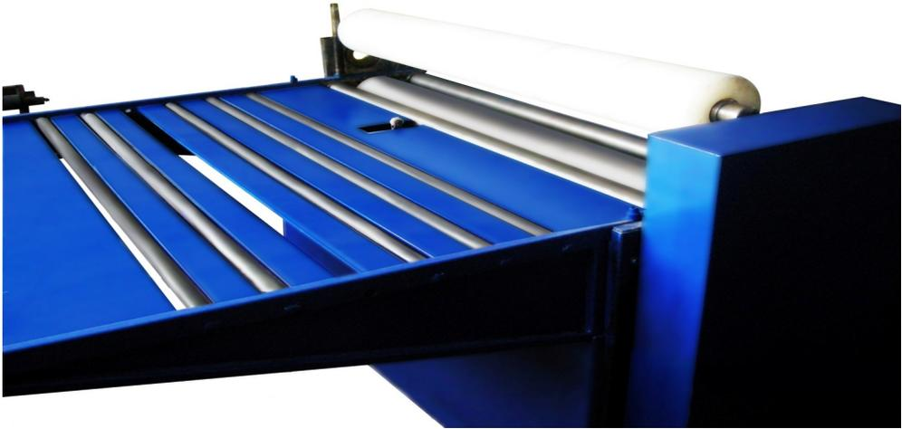
**Mašina poseduje dve radne površine koje povezuje metalni radni valjak  $\varnothing$  16cm, presvučen plastikom, u cilju zaštite metalnog alata za dati proizvod a istovremeno smanjuje jednu fazu proizvodnje jer se tako izbegava stavljanje fružen ploča za zaštitu što povećava ekonomičnost proizvodnje.**
